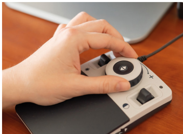
Darstellung eines speziellen Vergrößerungsgeräts für sehbeeinträchtigte Menschen
